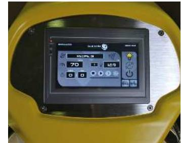
Impastatrici professionali con doppio motore, inversione di rotazione e controlli analogici, con motore trifase a due velocità e monofase con inverter ed infine la Queen line con pannello comandi touch screen, sensore temperatura ad infrarossi, inverter fino a 300rpm e doppio motore sia monofase che trifase.
